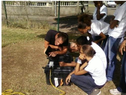
La méthode utilisée est la SASW ou « analyse spectrale des ondes de surface ». Elle permet de mesurer la vitesse des ondes sismiques dans les 30 premiers mètres de profondeur.
